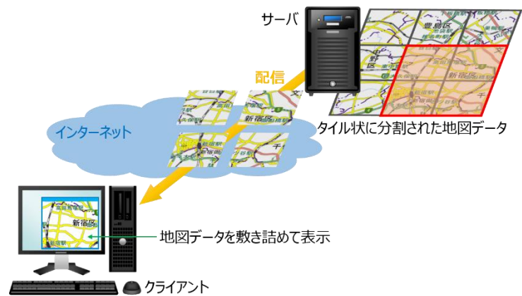
図 3 XYZ タイルを使用した地図データの配信 国土地理院のホームページから引用 ( https://maps.gsi.go.jp/development/siyou.html )
